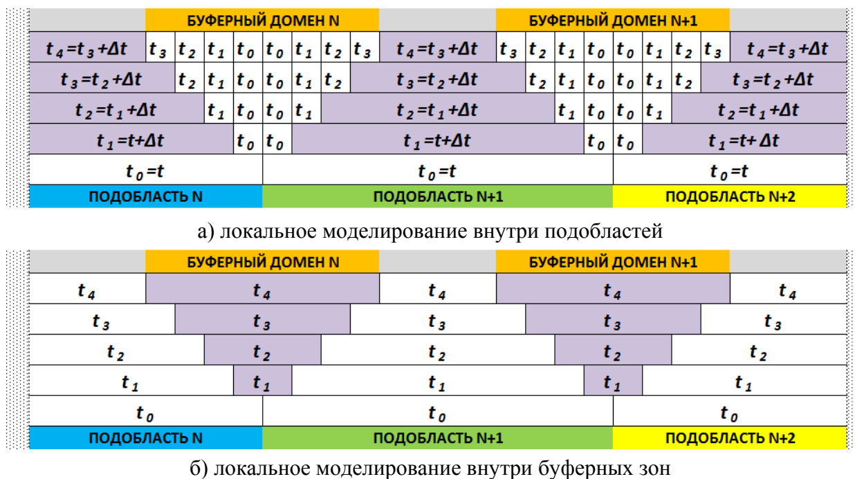
Рис.2. Пример асинхронной схемы вычислений при N_{step}=4 .
