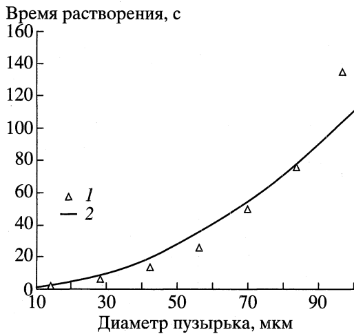
Рис. 2. Время растворения пузырьков в зависимости от их размера и вплоть до их исчезновения: 1 – экспериментальные точки, 2 – расчет по (1).
