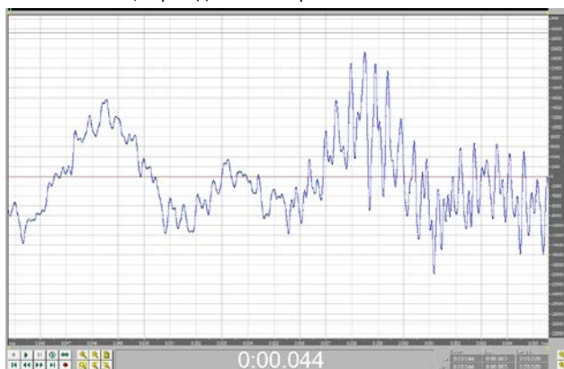
Рис. 12. Общая длительность 0,02 секунды. Переход от относительно гармоничных колебаний, к резкому возрастанию уровня гармоник.
