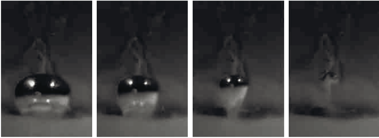
Рис. 9. Схлопывание парового пузыря (вид сбоку) [124]: интервал между кадрами – 100 мкс, плотность теплового потока – 1.5 \text{ МВт/м}^2 , величина недогрева – 76^\circ\text{C} , неподвижная вода, поверхность – алюминиевая пластина с покрытием из \text{Al}_2\text{O}_3 .
