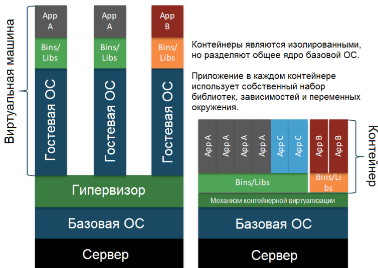
Рис. 1. Различие между виртуализацией с использованием гипервизора и контейнерной виртуализацией
