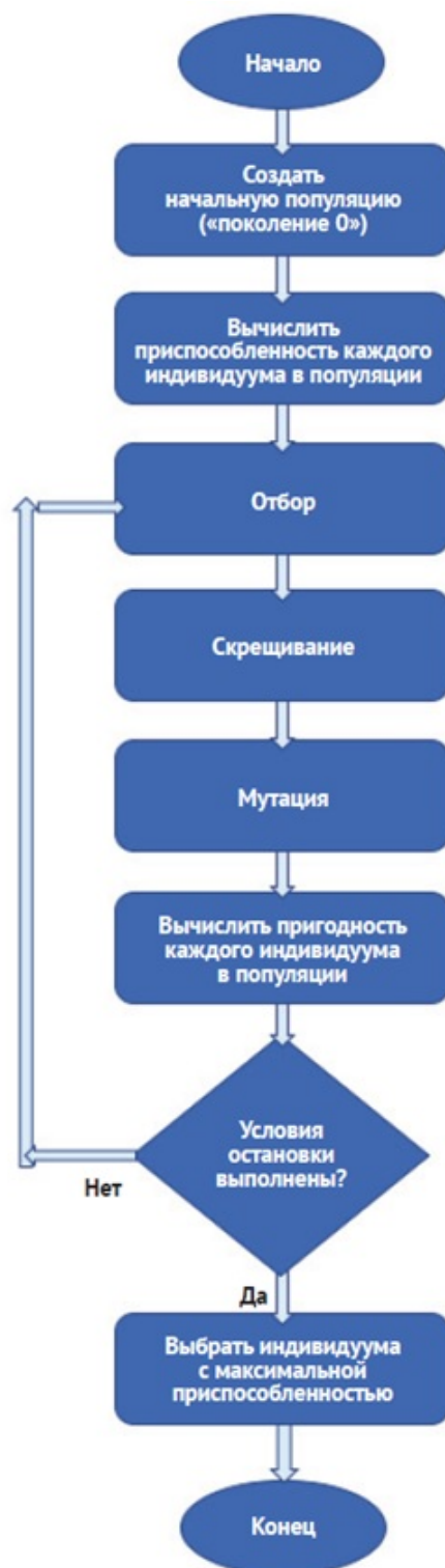
Рис. 1. Блок-схема работы генетического алгоритма [Figure 1. Block diagram of the genetic algorithm]
