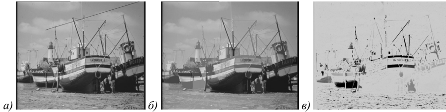
Рис. 4. Пример разложения изображения «Лодки» на две матрицы: исходное изображение (а), низкочастотная спектр-матрица разложения (б), высокочастотная спектр-матрица разложения (в)
