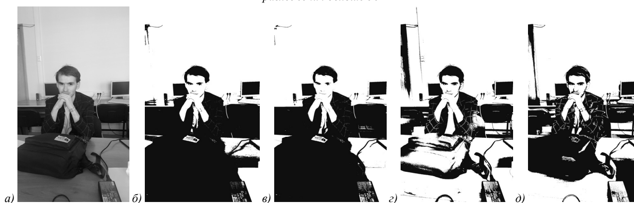
Рис. 6. Результаты бинаризации на изображении «Иван»: исходное изображение (а), метод Оцу (б), K-Means (в), адаптивная бинаризация (г), предложенный алгоритм (д), в котором функция f(M) – это разница между минимальным и максимальным значениями на матрице M в пределах от 30 до 150 и количество ненулевых точек на каждой матрице разложения больше 30
