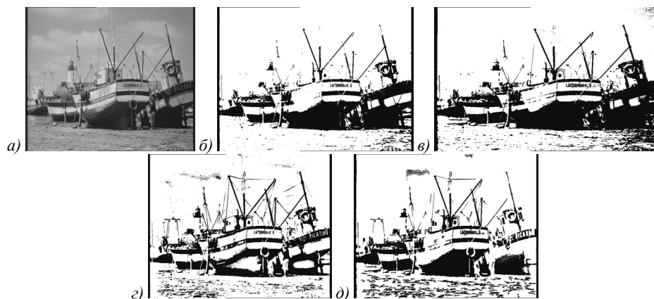
Рис. 5. Результаты бинаризации на изображении «Лодки»: исходное изображение (а), метод Оцу (б), K-Means (в), адаптивная бинаризация (г), предложенный алгоритм (д), в котором функция f(M) – это разница между минимальным и максимальным значениями на матрице M в пределах от 15 до 142 и количество ненулевых точек на каждой матрице разложения больше 50
