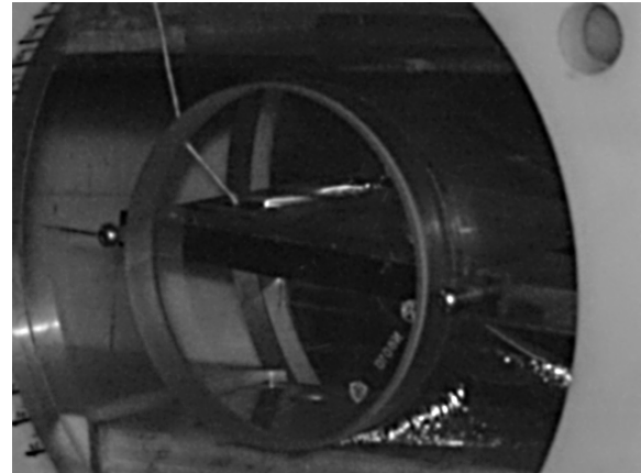
Рис. 1. Схема модели NASA23012, размещение ее в рабочей секции аэродинамической трубы и фотография ВЧ-разряда на поверхности модели: 1 – диэлектрическая вставка, 2 – ВЧ-электроды, 3 – модель крылового профиля, 4 – набор трубок Пито, 5 – тензорезисторные веса.
