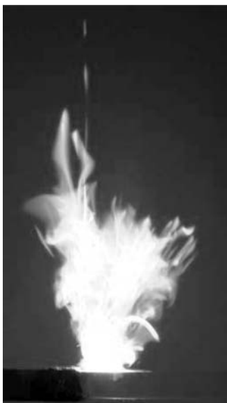
Рис. 2. Интегральная (без временного разрешения) фотография воспламенения с помощью импульсного поверхностного СВЧ-разряда в неподвижном воздухе тонкой пленки бензина, нанесенной только на верхнюю поверхность горизонтально расположенной антенны. Давление воздуха – 760 Тор, длительность СВЧ-импульса – 100 мкс, импульсная СВЧ-мощность – 55 кВт, время экспозиции кадра t = 2 с.
