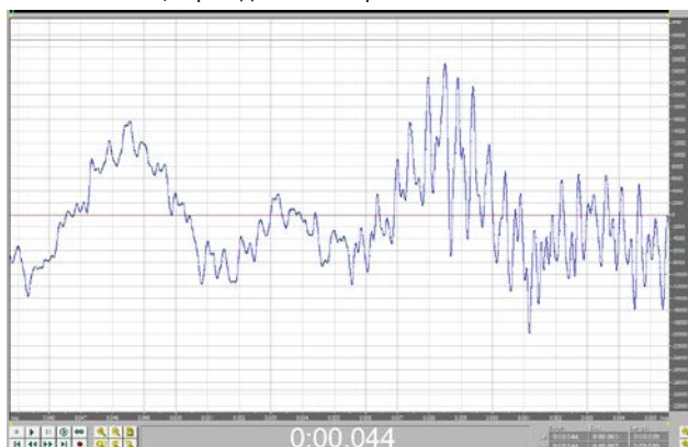
Рис. 12. Общая длительность 0,02 секунды. Переход от относительно гармоничных колебаний, к резкому возрастанию уровня гармоник.
