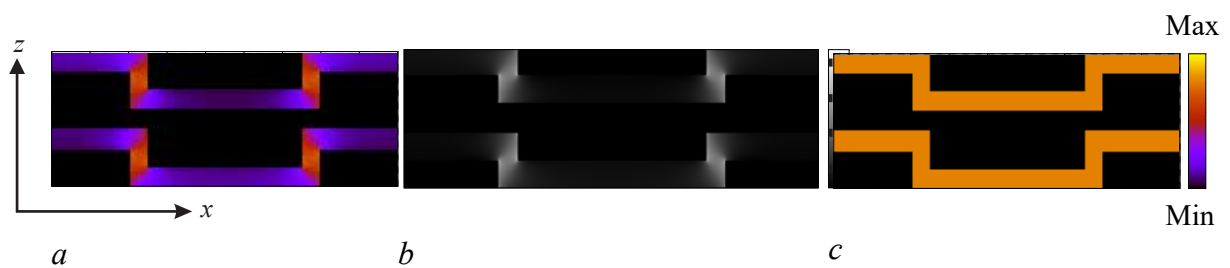
Рис. 4. Результаты моделирования внутреннего эффективного магнитного поля. Параметры пластинок: d = 1 мкм, h = 4 мкм, параметры поля: H_0 = 2100 Э, 4\pi M = 1750 Гс. Z -компоненты поля по высоте при ПОМСВ и ООМСВ (a), ПМСВ (b), ООМСВ (c)
