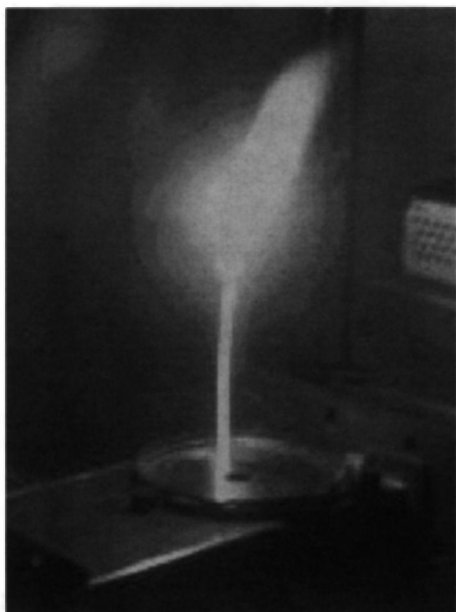
Рис. 6. Факельный разряд в однопроводной линии Губо длиной 32 см.
