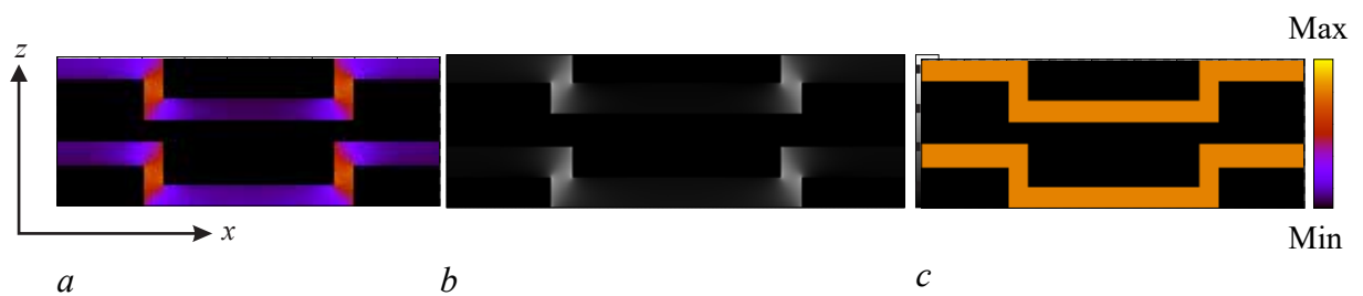
Рис. 4. Результаты моделирования внутреннего эффективного магнитного поля. Параметры пластинок: d = 1 мкм, h = 4 мкм, параметры поля: H_0 = 2100 Э, 4\pi M = 1750 Гс. Z -компоненты поля по высоте при ПОМСВ и ООМСВ (a), ПМСВ (b), ООМСВ (c)
